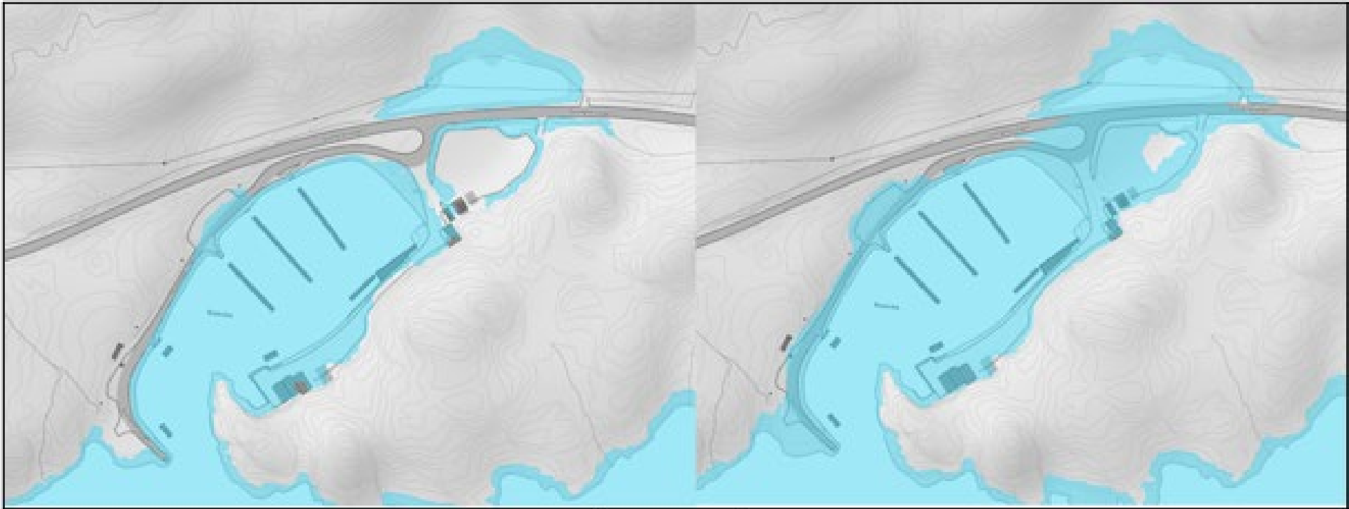
Figur 12: Kartutsnittet til venstre viser havnivå ved 200-års stormflo no, og kartutsnittet til høgre viser havnivå ved 20-års stormflo i 2090 ( https://www.kartverket.no/til-sjos/se-havniva/kart ).
