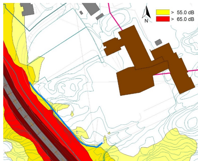
Figur 4-4 Framstilling av stille utendørs oppholdsarealer på bakkeplan. L_{de} støykoter ved 1,5 meter beregningshøyde. Etter skjermingstiltak.
