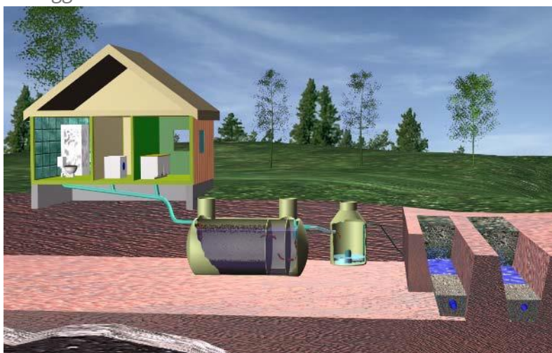
Figur 5: Eksempelskisse over eit infiltrasjonsanlegg med infiltrasjonsfilter.
