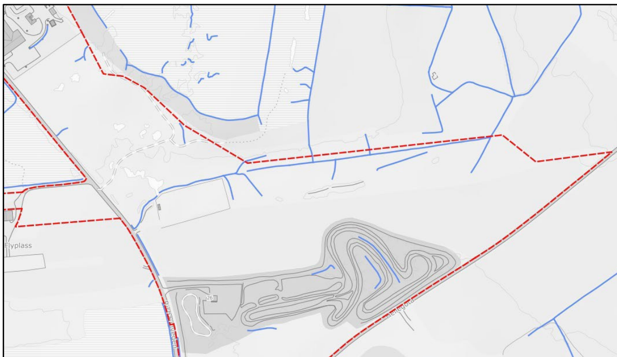
Figur 10: Kartutsnitt som viser eksisterande kanalsystem som i området der nye motorsportføremål er tenkt etablert (blå strek).
