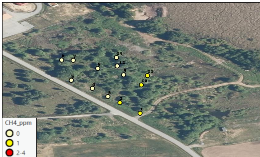
Figur 9 Målte konsentrasjoner av emisjoner av CH 4 fra overflaten. Skalaen i ppm er vist nederst til venstre. Kartet er fremstilt i ArcGIS Pro.
